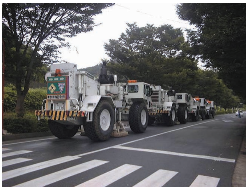
写真1 陸上では主にパイロサイス（起振車）と呼ばれる装置で弾性波を震しました（三浦半島）
