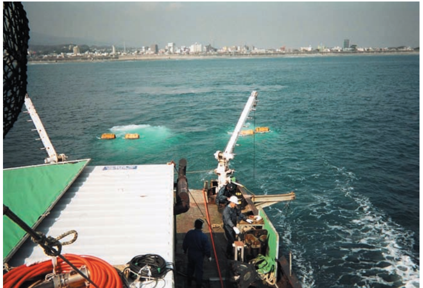
写真2 相模湾でのエアガンによる発震作業。放出された圧搾空気が白い泡となっています。
