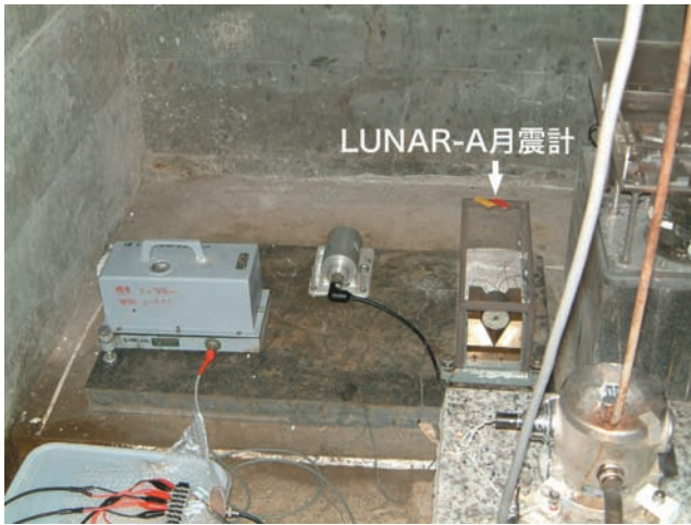
写真3 名古屋大学犬山地震観測所の坑道内での比較観測
