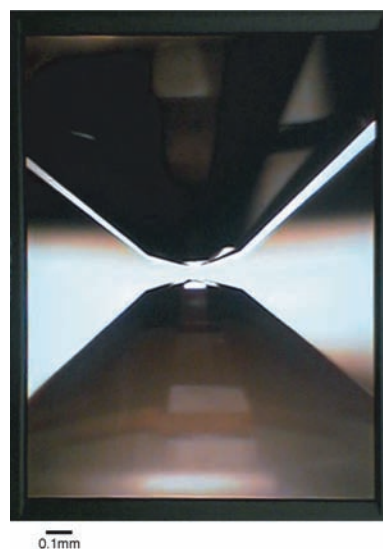
写真 超高压を発生するダイヤモンドアンビルの先端部。先端の直径は60ミクロン。
