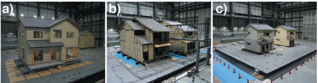
図4 木造住宅の加振実験の様子。a) 免震・耐震復旧試験体、b) 京都の町家試験体、c) 補強・無補強試験体。
