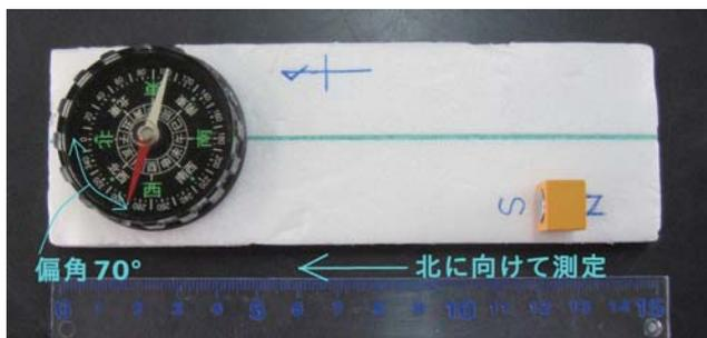
極を北に向けた小型磁石を、方位磁石の北と南を結んだ線より西側におきます。そして、方位磁石がうまく斜めになるように方位磁石と小型磁石の距離を調節して、小型磁石を両面テープで固定します。原理はちょうどシーソーのようなものです。周りの磁場（地磁気）が強くなると、方位磁針は北を向こうとします。逆に周りの地磁気が弱くなると方位磁針は小型磁石のS極に引っ張られて直角方向を向こうとします。色んな場所でこの装置を南北に保って、方位磁針の北からの偏角を測るとその場所の地磁気の南北方向の強さを測れるというわけです。校舎内や自宅の中など色んなところで地磁気の強さを測って比べてみましょう。参考のために、磁気センサとの比較データをグラフにしておきます（下図）。
