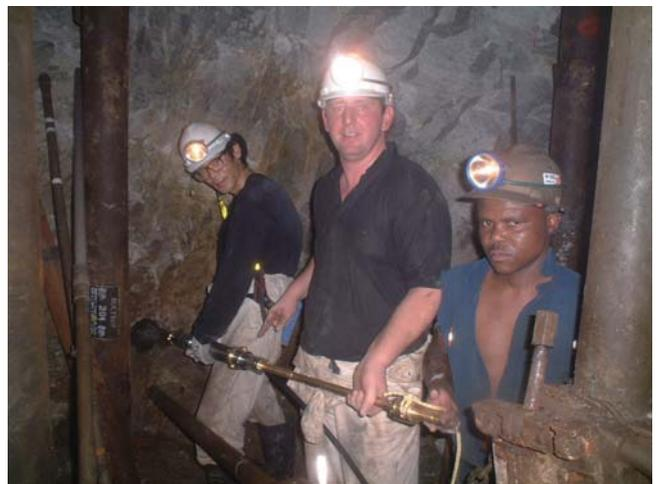
写真 予想震源のごく近傍の岩盤に高感度ひずみ計を埋設する様子。太い鉄柱は落盤防止のためのものです。
