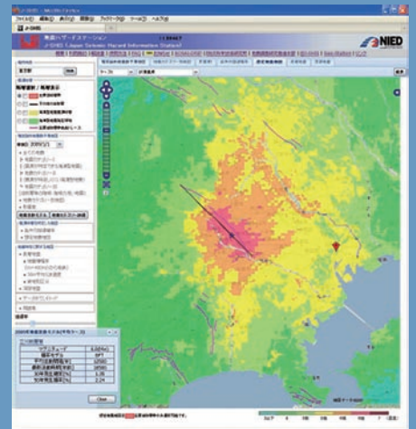
図3 関心のある主要断層帯(赤い矩形)をクリックして選択すると、その断層帯の活動度が表示されます。さらに、「想定震源地図」タブをクリックすると、震源断層を特定した地震動予測地図が表示されます(立川断層帯の例)。
