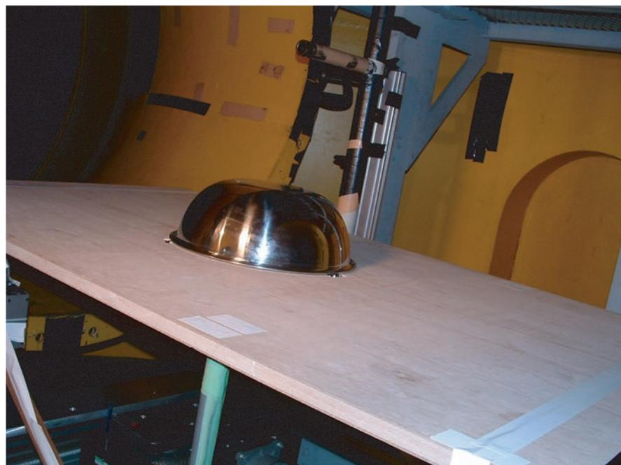
図4 地震計の覆いの効果を確認するための風洞実験のようす。0.1気圧程度に減圧された容器内で、左側から風速30m/sまでの風を当て、覆いが受ける力や振動を測定しました。
