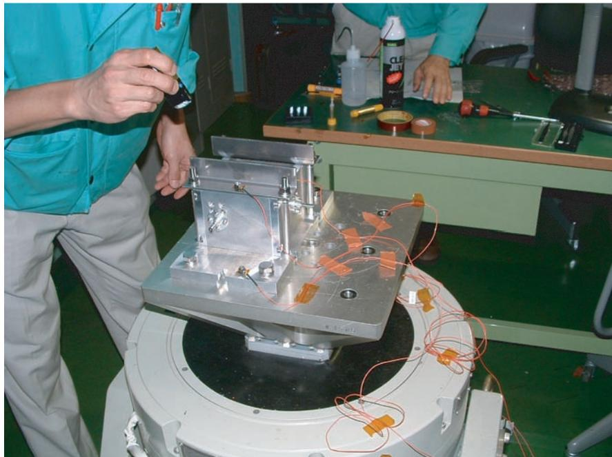
図3 長周期振り子の模型を使った振動試験のようす。H2Aロケットの振動波形を加え、振り子のヒンジ部分の損傷や固有周期の変化などを調べ、試作機の設計に反映させました。
