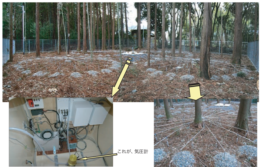
図3 千葉県いすみ市にあるインフラサウンドの観測施設。風の影響を少なくするため、林の中に設置されています。中央の半ば埋まった箱の中に気圧計が入っていて、気圧計は、四方に伸びたパイプとつながっています。パイプの先端（砂利に埋まっているところ）が開放されているので、その場所の微小な圧力変動を観測していることになります。パイプの先端は、全部で96箇所。それが、概ね20m四方にまんべんなく展開されています。これは、風がつくる局所的な影響を低減するための工夫です。
