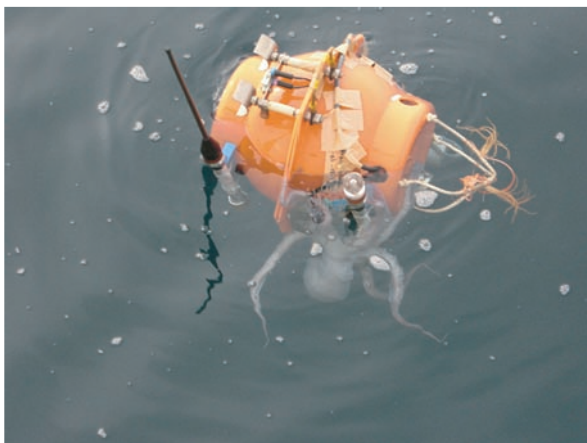
写真3 回収のために海面に浮上させた水圧計。下にタコが見える。
