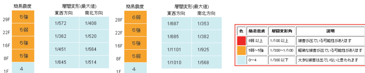
図3 2011年東北地方太平洋沖地震時の工学院大学(左)とエステック情報ビル(中)における被災度判定結果(簡易震度と層間変形角)と、結果の解説(右)
