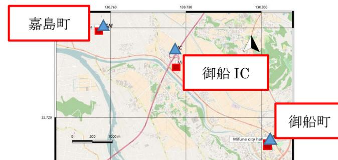
図1：地震計の位置(■)と常時微動アレー観測の実施箇所(▲)
