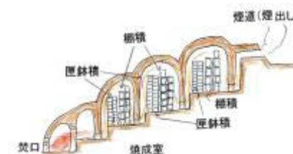
図2 登り窯の模式図 wikiwandより
