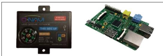
図1. ユニットに使用する加速度センサー(左)と小型コンピュータ Raspberry Pi(右)
