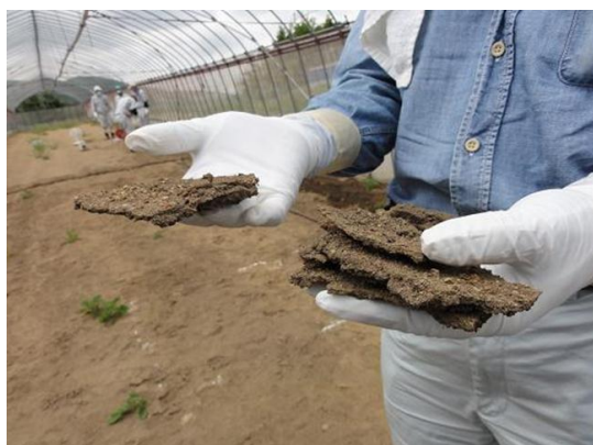
図3 天然ポリイオンコンプレックスで固定化し剥離された土壌片
