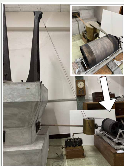
図1 大森式地震計(東京大学地震研究所 地震計博物館)
