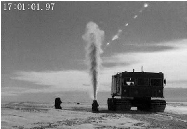
左：南極での人工地震の瞬間（標高2000m、2000年1月28日）。実際の発破点は、雪上車と人物2名の後方約300m地点に位置しています。 右：氷床掘削孔への火薬装填作業。（写真提供：宮町宏樹氏、柳沢盛雄氏）
