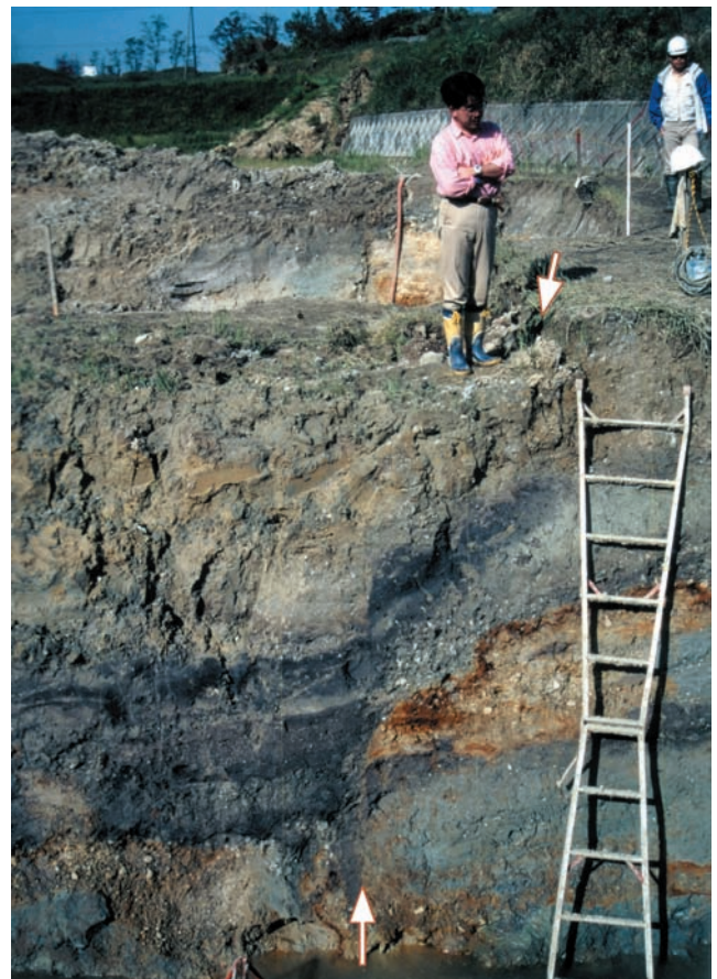
野島断層におけるトレンチ調査[注3]の風景（渡辺満久氏撮影）。矢印で示した地層のずれている所が断層。
